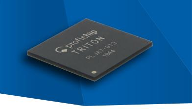
Triton は、産業用ギガビット イーサネット通信と、高速で信頼性の高い バックプレーン システム、および強力なモーション/オートメーション マルチコアプロセッサを低消費電力のデバイスの中に組み込んでいます。
